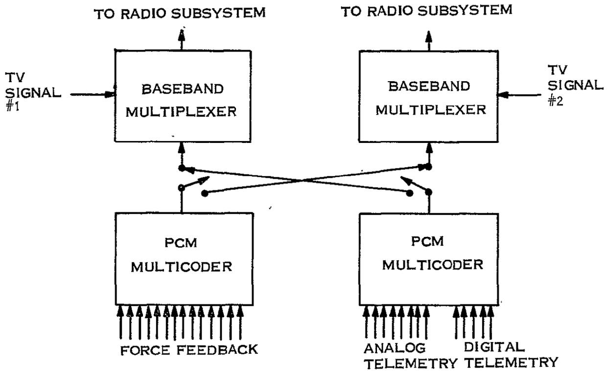
Figure 9.4-8. Data Handling Subsystem Block Diagram
