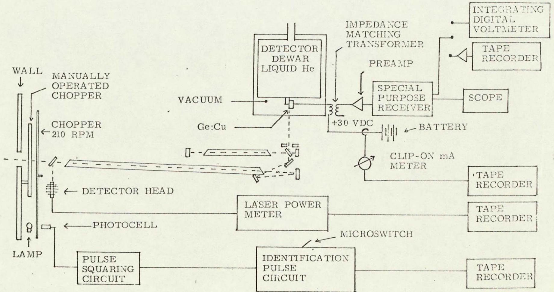
Fig. 20 .- The detection circuit.
