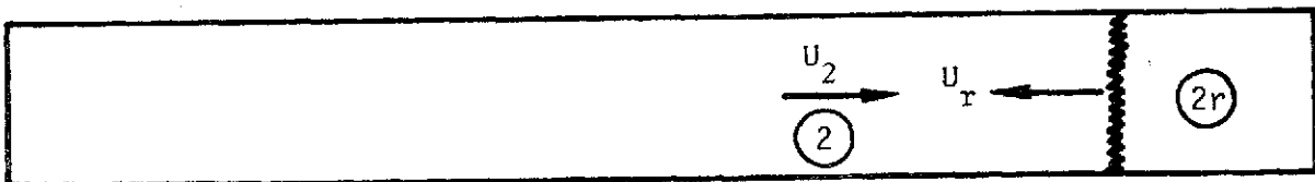
(d) Reflected normal shock from end wall.
