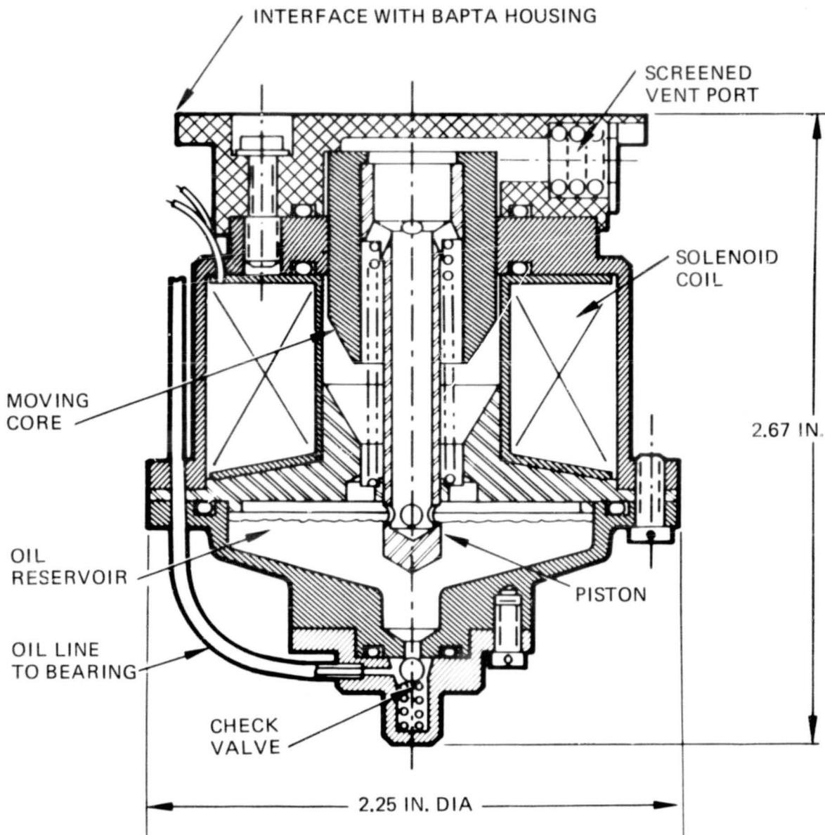
FIGURE 2. CROSS-SECTION OF SOLENOID-ACTIVATED OILER
