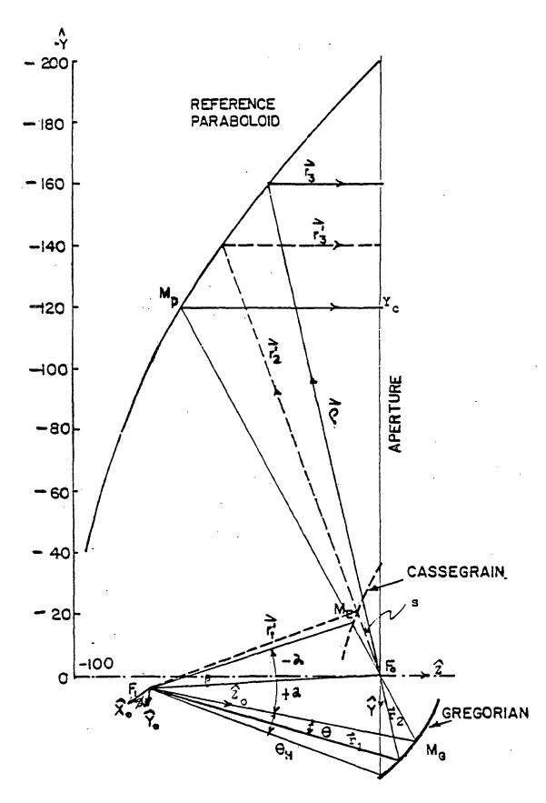
FIG.3.10FFSET DUAL REFLECTOR GEOMETRY FOR REFERENCE SURFACES
