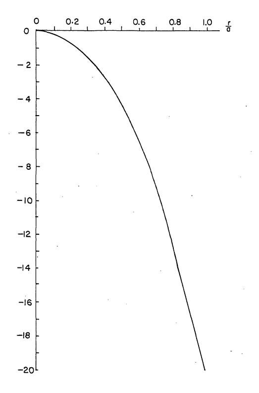
FIG.3.11ILLUMINATION OF CIRCULAR APERTURE BY 76.2 cm LONG CORRUGATED HORN
