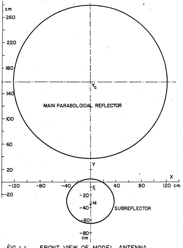
FIG. 3.3, FRONT VIEW OF MODEL ANTENNA
