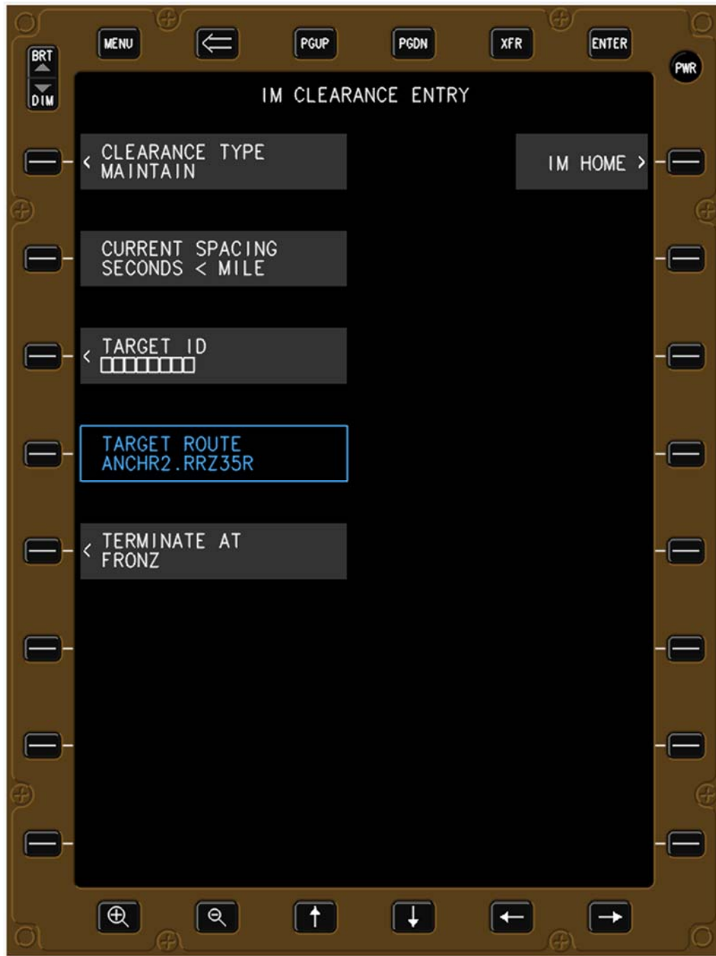
Figure 14. IM MAINTAIN Clearance Entry page.
