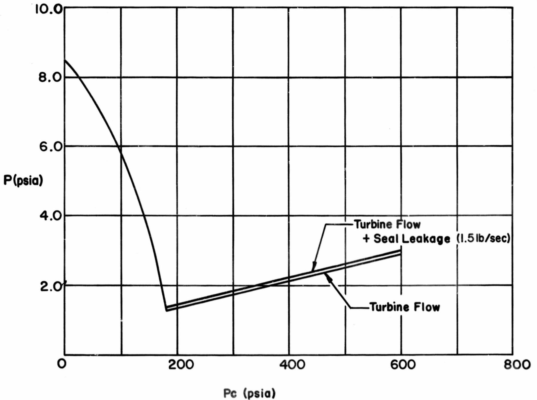
ENGINE COMPARTMENT PRESSURE  $P_v$ , Vs 10/1 CONICAL NERVA NOZZLE CHAMBER  $P_c$  .
