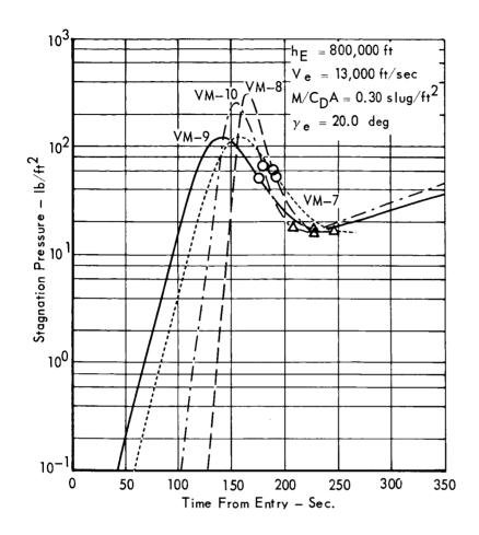
$$--- \frac{PSTAG}{P} = \left[ \frac{(\frac{\gamma+1}{2}M^2)^{\gamma}}{\frac{2\gamma}{\gamma+1}M^2 - \frac{\gamma-1}{\gamma+1}} \right]^{\frac{1}{\gamma-1}}$$
