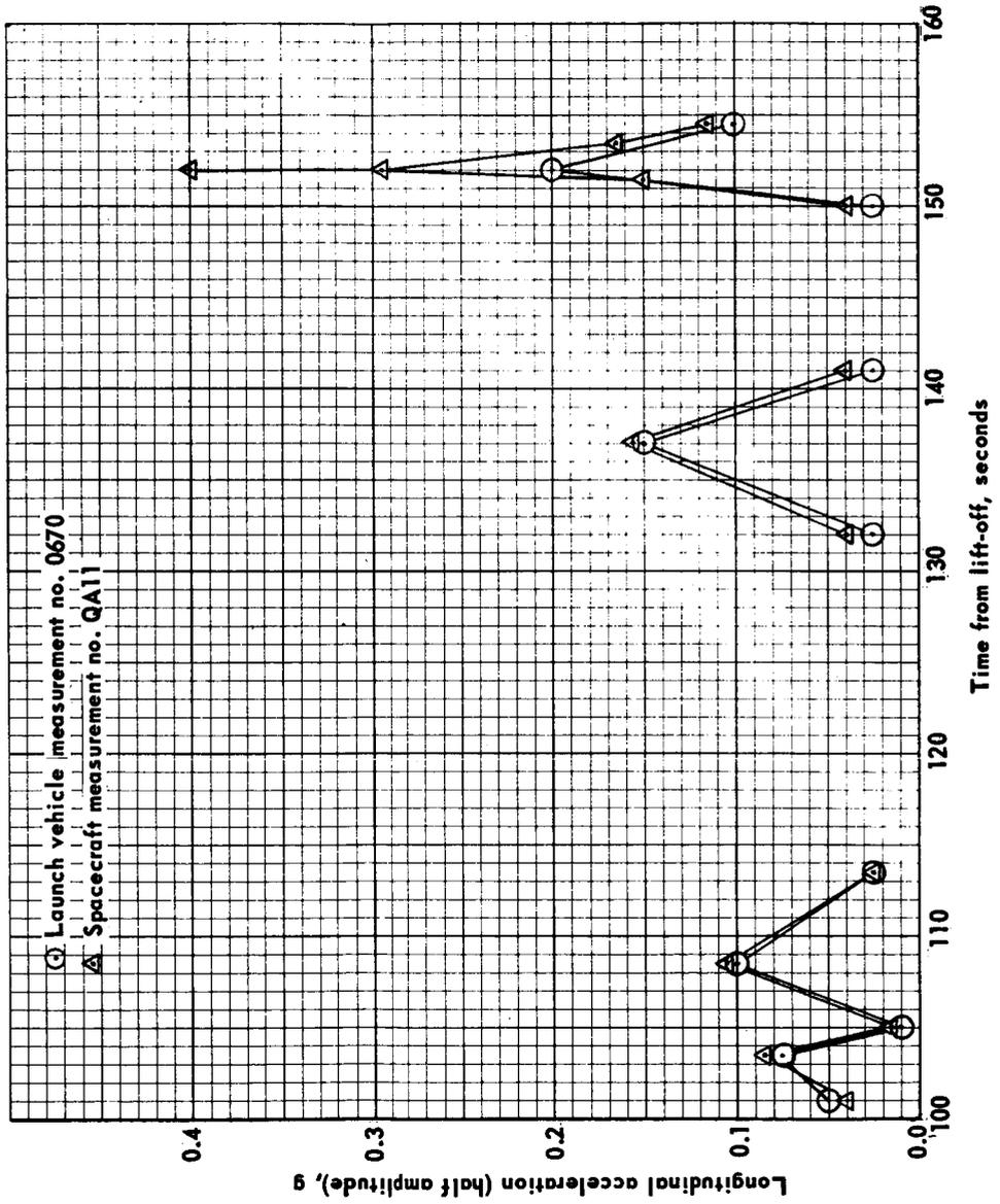
FIGURE 5-18 LONGITUDINAL OSCILLATION
