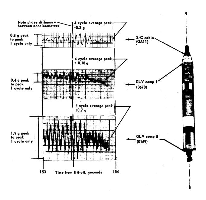
FIGURE 5-19 LOW FREQUENCY LONGITUDINAL OSCILLATION MEASUREMENTS
