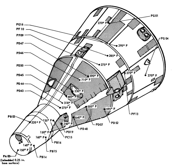
FIGURE 5-5 DISTRIBUTION OF PEAK MEASURED TEMPERATURES
