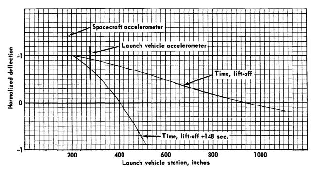
FIGURE 5-20 LONGITUDINAL MODE SHAPE
