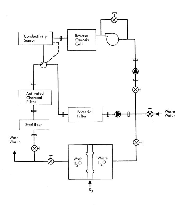
Figure D-4: REVERSE OSMOSIS SYSTEM SCHEMATIC
