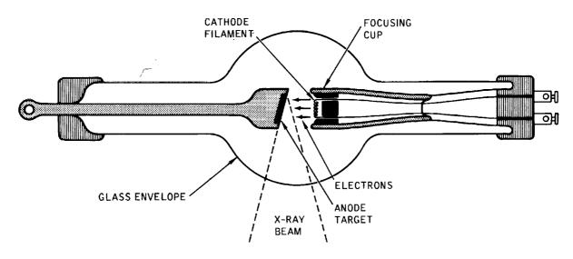
Figure 2-7. Basic X-Ray Tube
