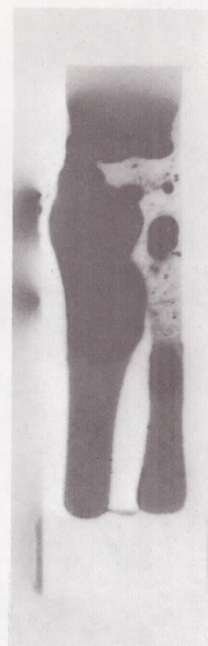
(d) Autoradiograph, sectioned capsule after 200 hours.
