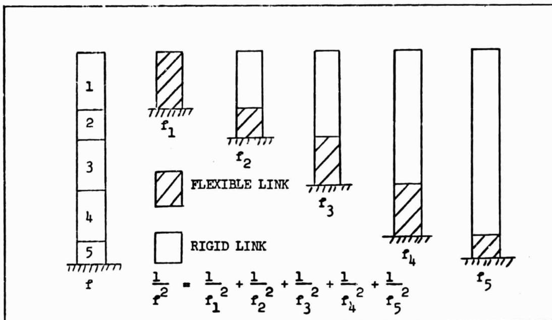
FIGURE 2.2-10 - FREQUENCY ESTIMATION TECHNIQUE
