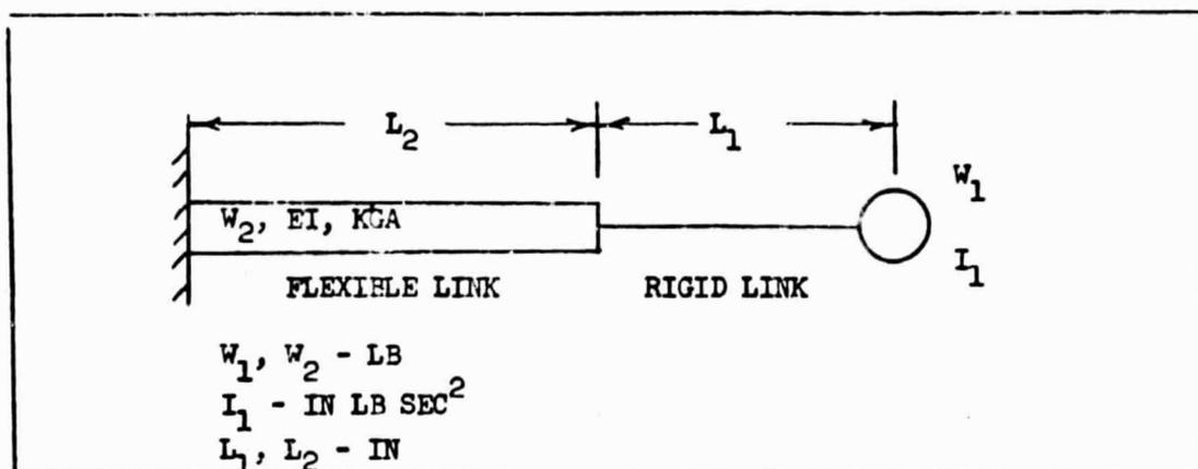
FIGURE 2.2-11 - TYPICAL LINK MODEL
