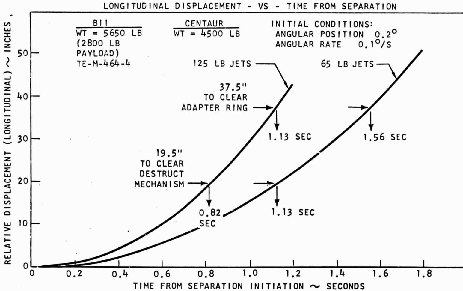
FIGURE 2.2-6a: CENTUAR-BURNER II-SEPARATION
