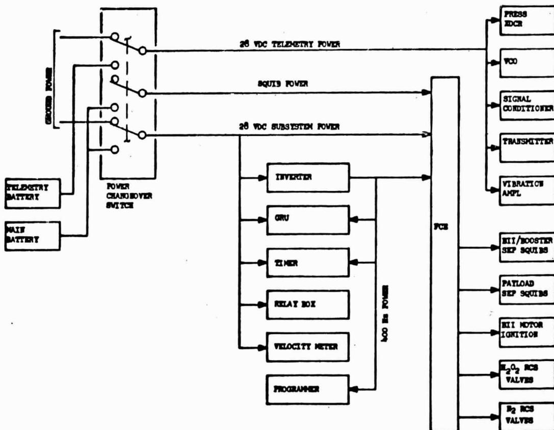
FIGURE 2.3-1 ELECTRICAL POWER AND DISTRIBUTION
