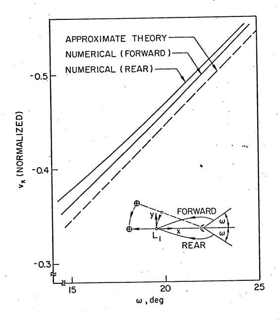
FIGURE 6.4. AXIAL VELOCITY COMPONENT V AT L VS ORIENTATION ANGLE  $\boldsymbol{\omega}$  .
