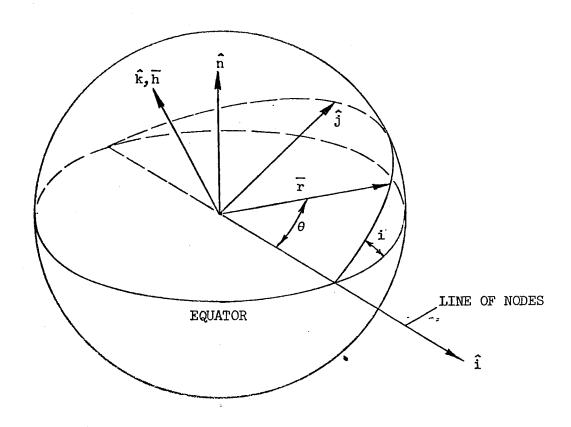
FIGURE 5.1. VECTOR GEOMETRY FOR REFERENCE CIRCULAR ORBITS.
