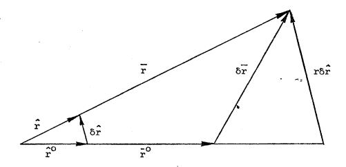
FIGURE 4.1. RELATION BETWEEN VECTOR VARIATIONS OF FOCAL OSCILLATOR SYSTEM.
