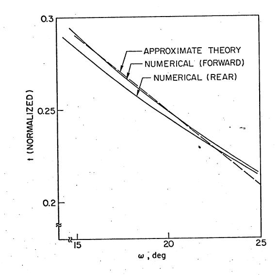
FIGURE 6.3. TRANSIT TIME BETWEEN PERILUNE AND L VS ORIENTATION ANGLE  $\boldsymbol{\omega}$  .
