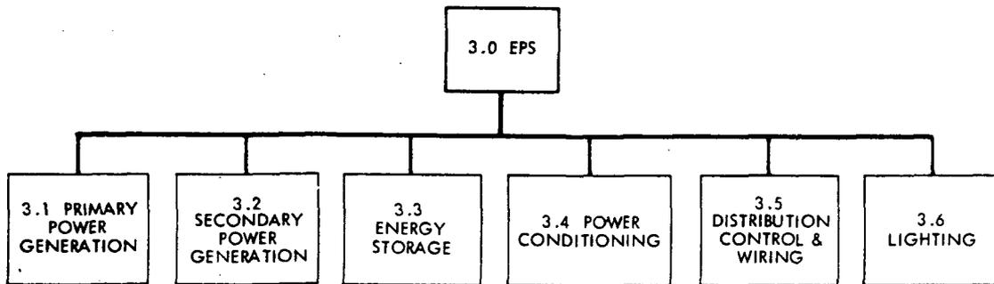
Figure 26. Electrical Power Subsystem (EPS)
