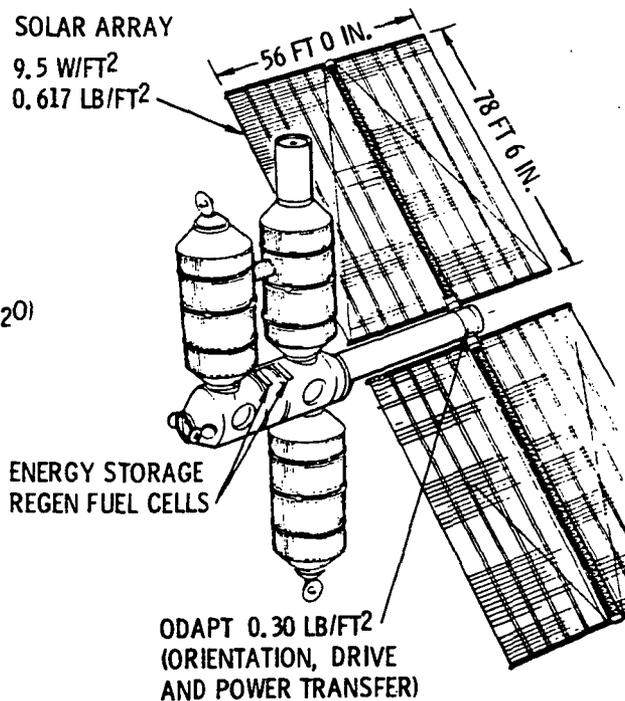
Figure 27. EPS Concept Selection - 14-Foot Phase B
