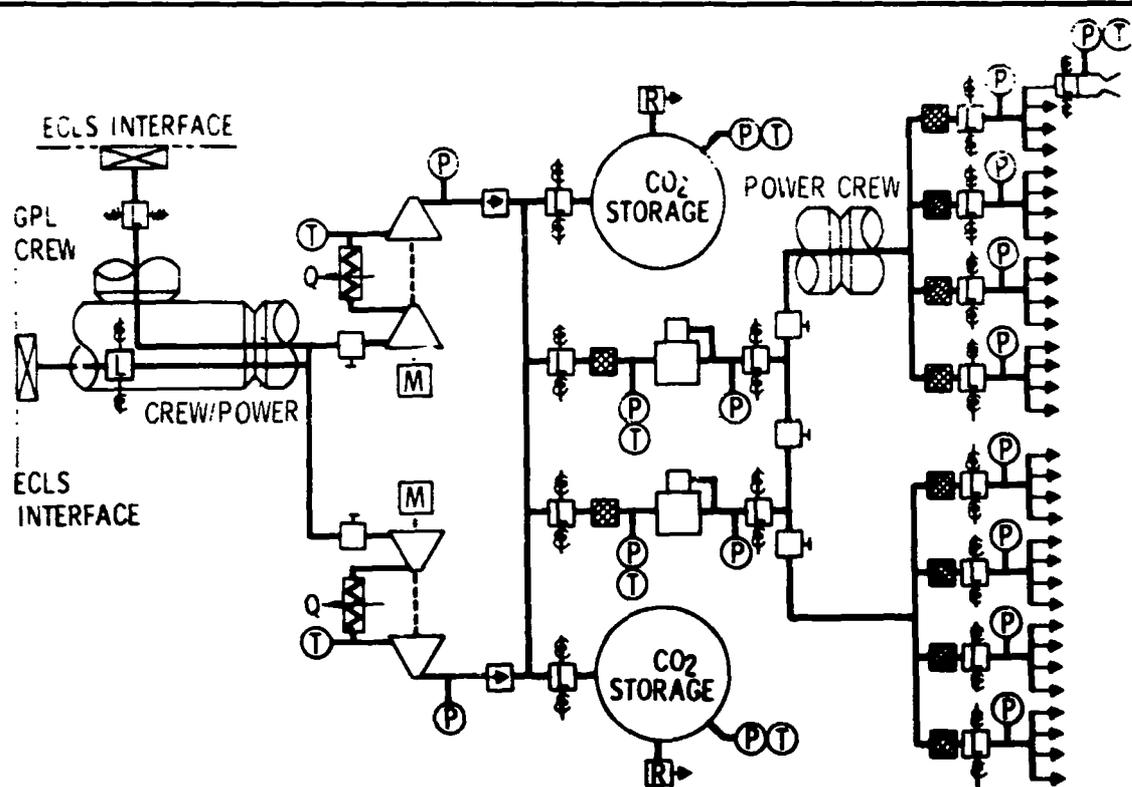
Figure 7-7. Low-Thrust Subsystem Schematic
