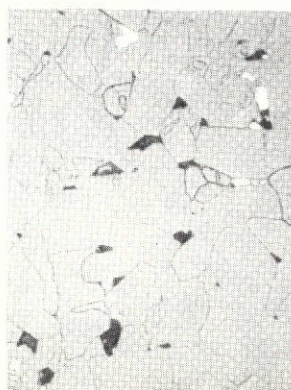
AVCO, 14 μm x 40 μm TABULAR GRAINS
