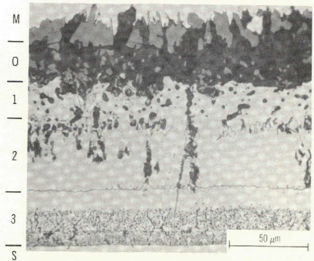
(d) R512E coated C-129Y after 24 cycles.
