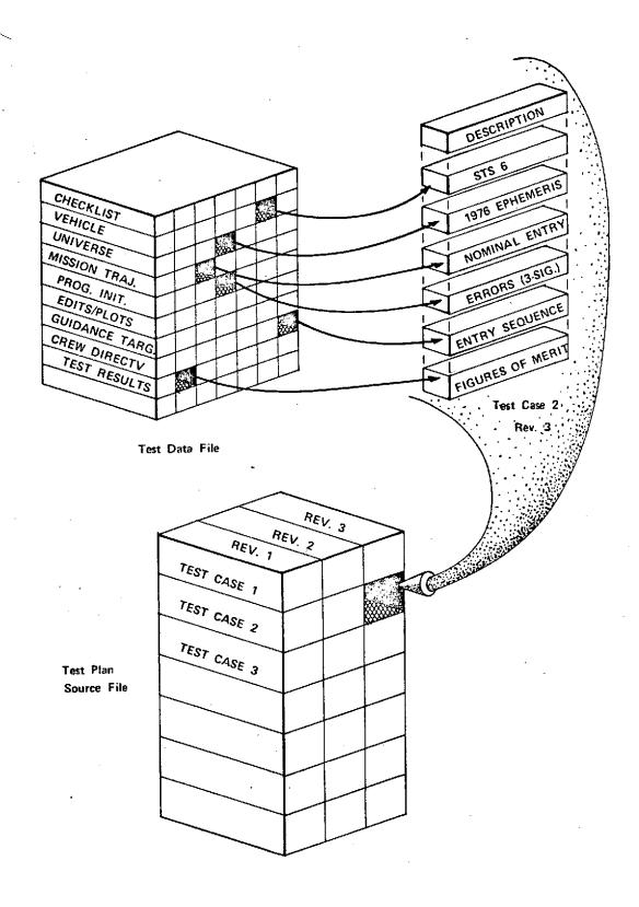
Figure 3-6. Test-Plan Source File
