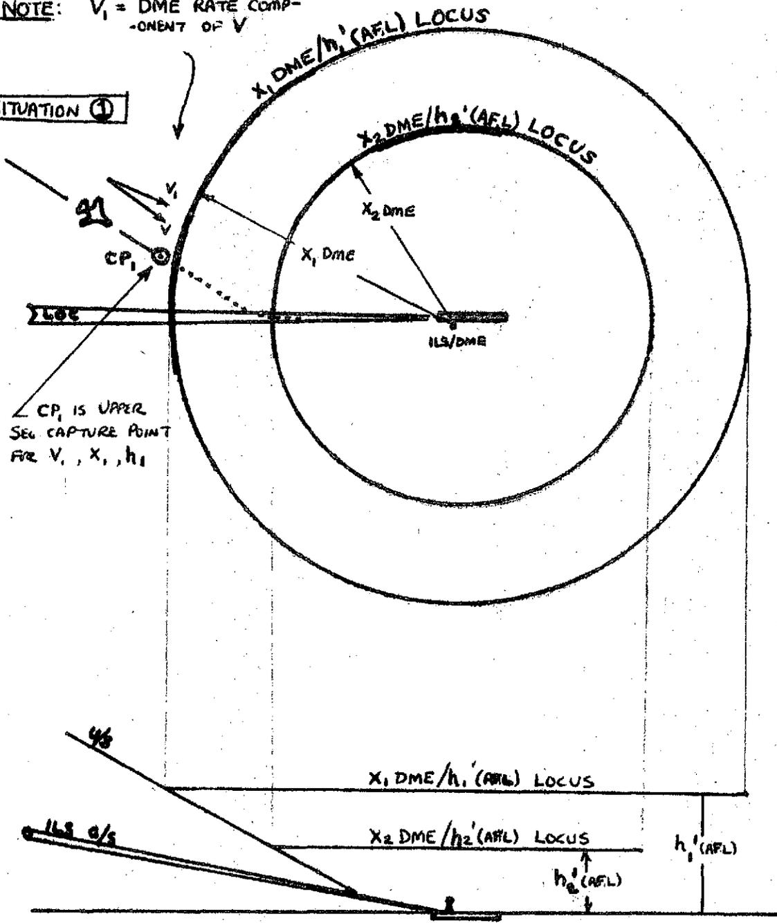
$CP_1$  IS UPPER SEG CAPTURE POINT FOR  $V_1, X_1, h_1$
