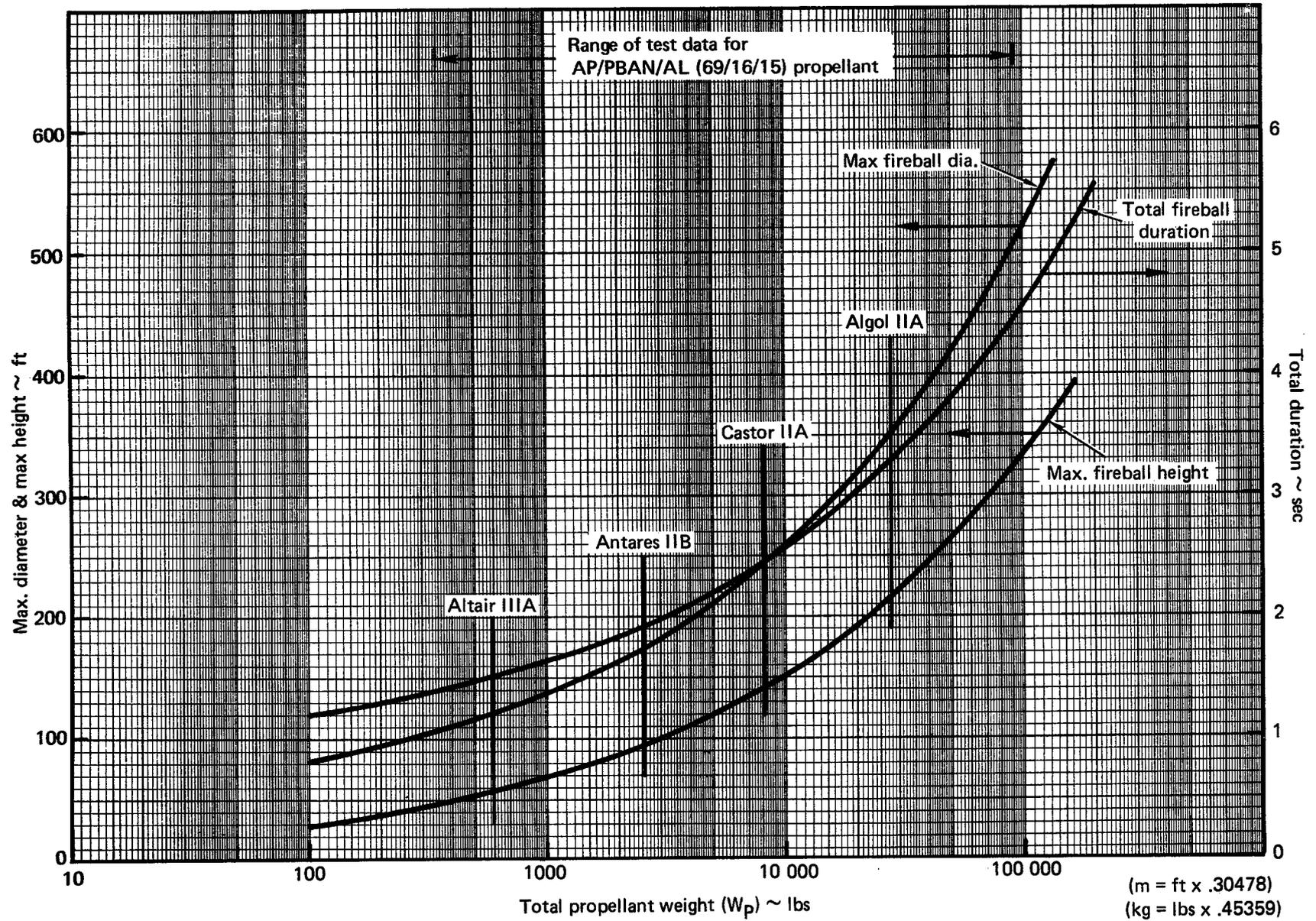
FIGURE 5-16. — ESTIMATES OF FIREBALL CHARACTERISTICS — SOLID SYSTEMS
