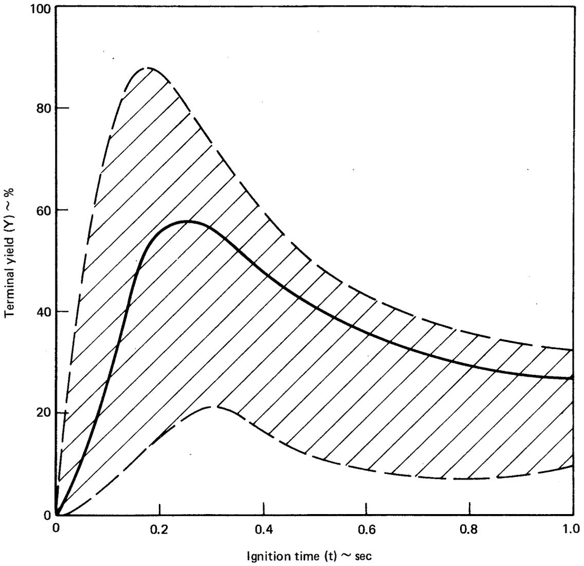
FIGURE 5-25. — TERMINAL YIELD VS IGNITION TIME FOR LO<sub>2</sub>/LH<sub>2</sub> CBM (REF. 54)
