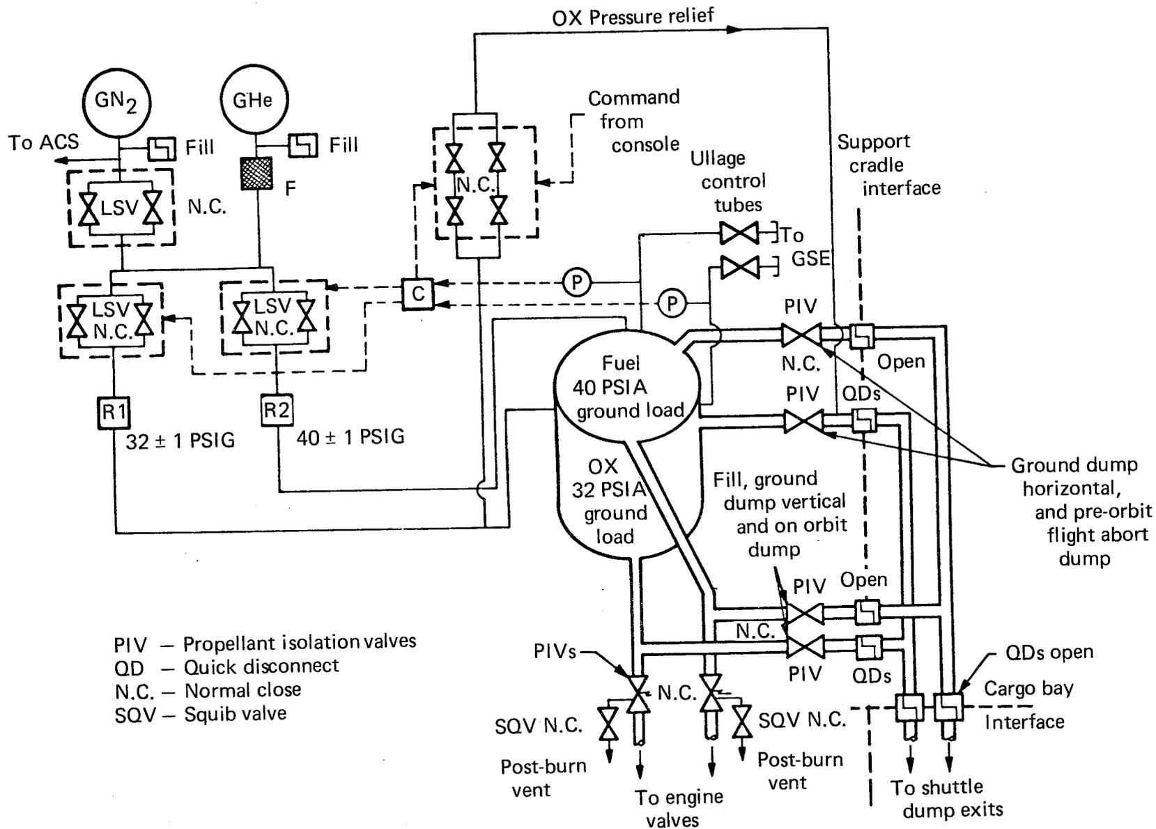
FIGURE 6-11. — AGENA PROPULSION SCHEMATIC
