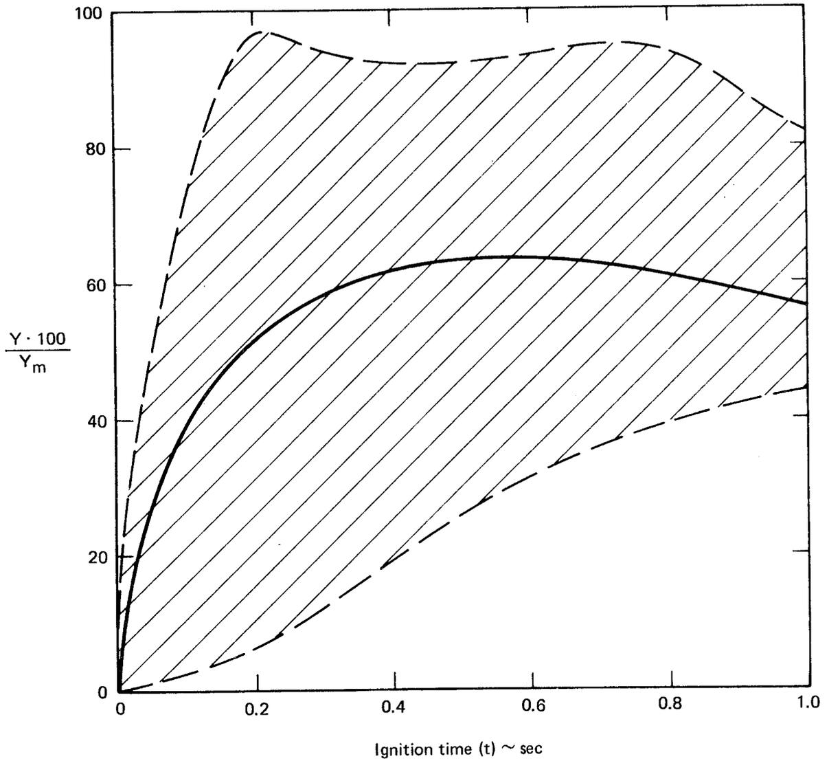
FIGURE 5-26. — NORMALIZED TERMINAL YIELD VS IGNITION TIME FOR  $LO_2/LH_2$  CBGS (REF. 54)
