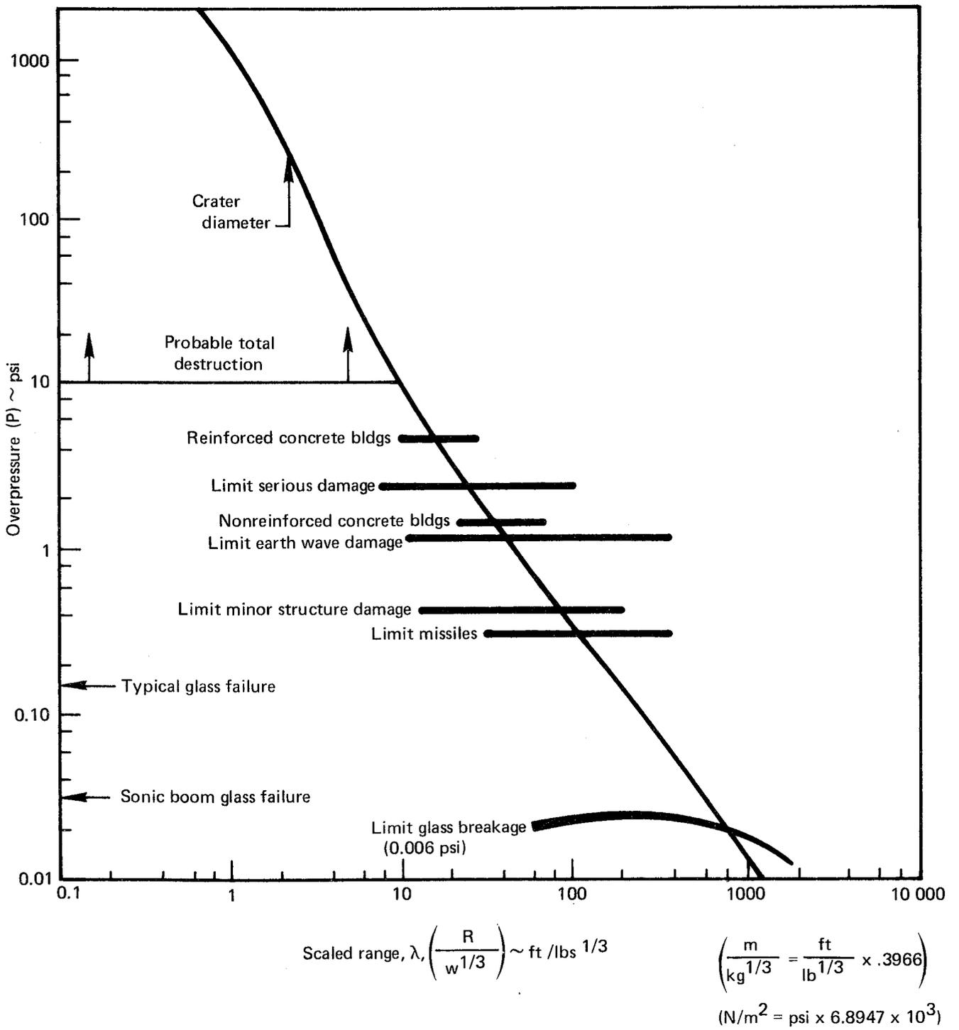
FIGURE 5-11. — OVERPRESSURE SCALED DISTANCE PLOT SHOWING TYPICAL LEVELS FOR BLAST DAMAGE (REF: 2)
