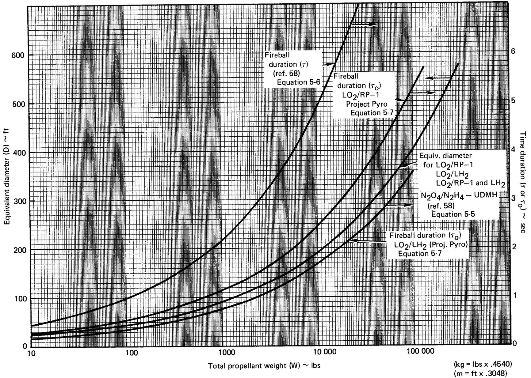
FIGURE 5-39. - ESTIMATES OF FIREBALL CHARACTERISTICS - LIQUID SYSTEMS
