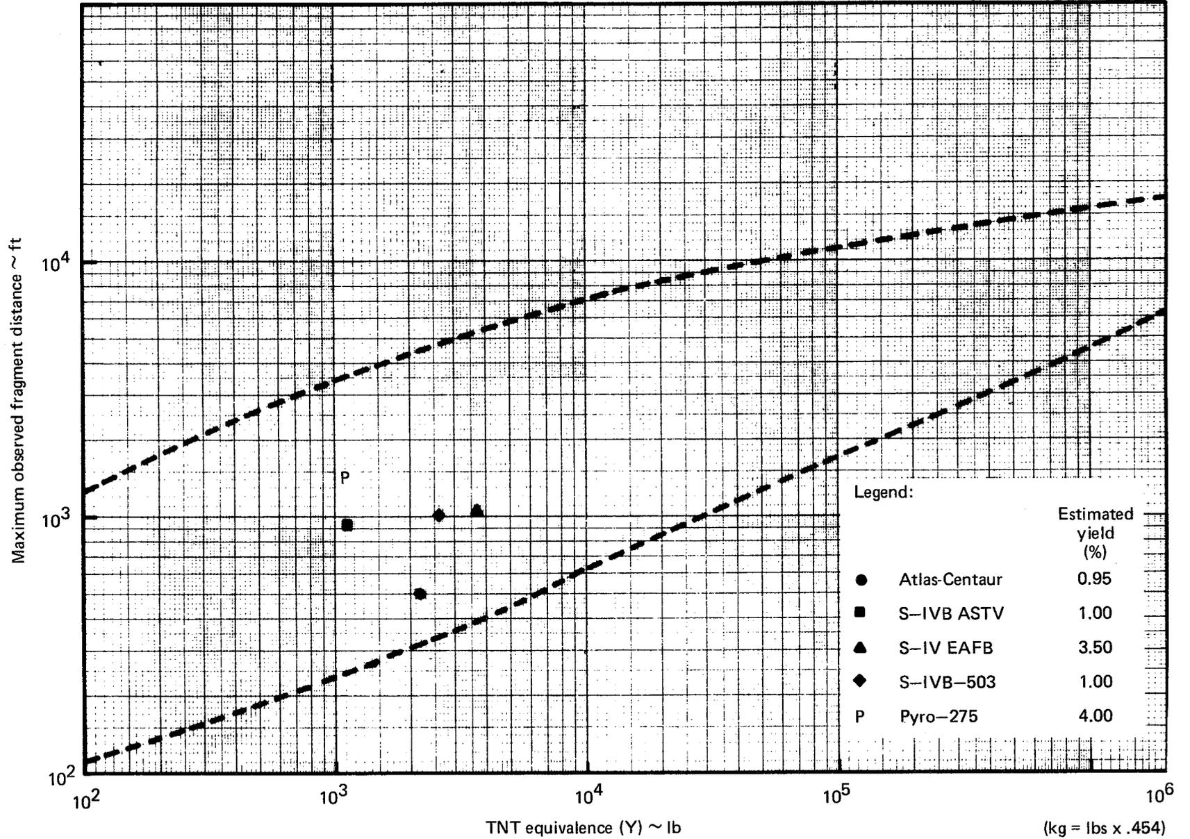
FIGURE 5-43. — ESTIMATED TNT EQUIVALENCE VS. MAXIMUM FRAGMENT DISTANCE FOR ACTUAL SPACE VEHICLE EXPLOSIONS (REF. 61)
