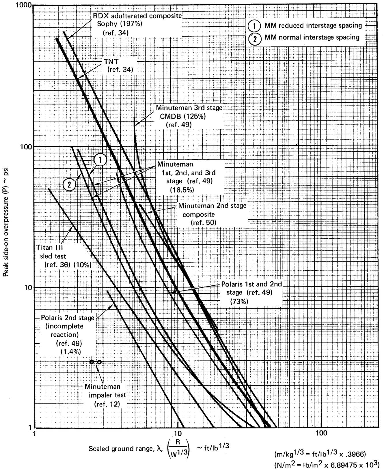
FIGURE 5-13. — PEAK SIDE-ON OVERPRESSURE VS. SCALED GROUND RANGE
