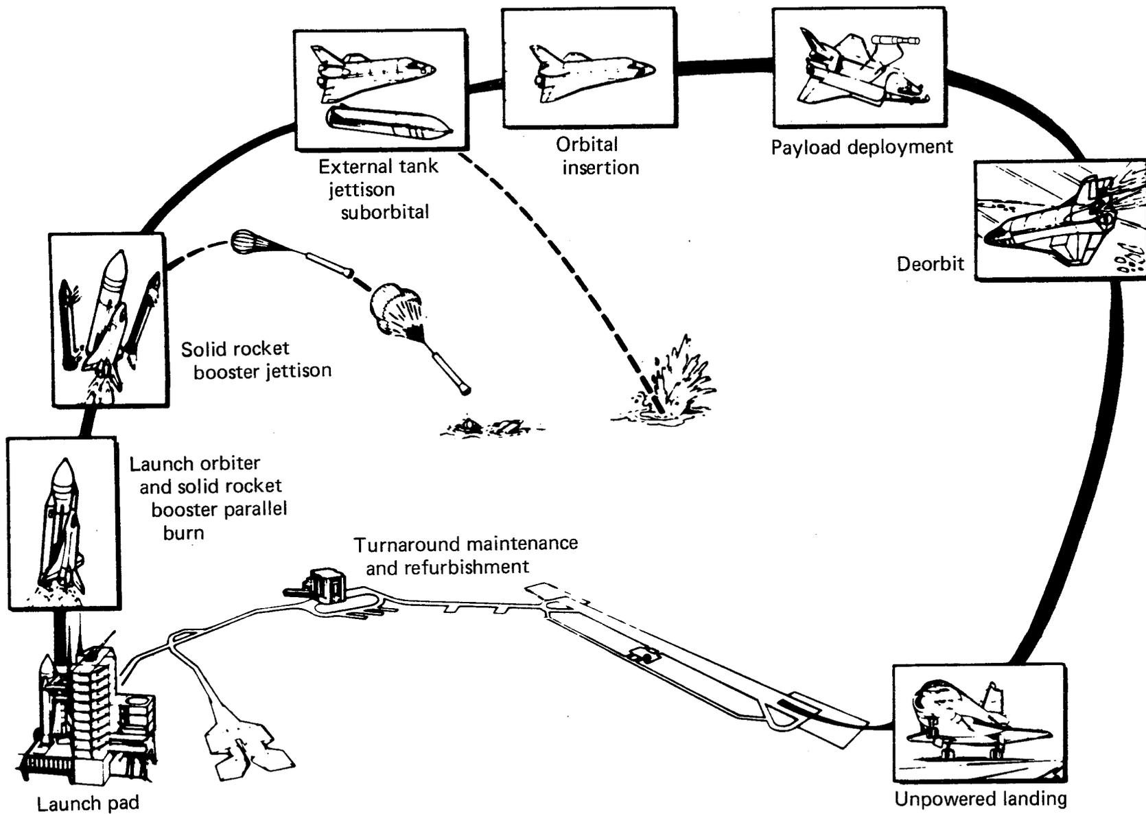
FIGURE 6-6. — TYPICAL ORBITER VEHICLE MISSION PHASES
