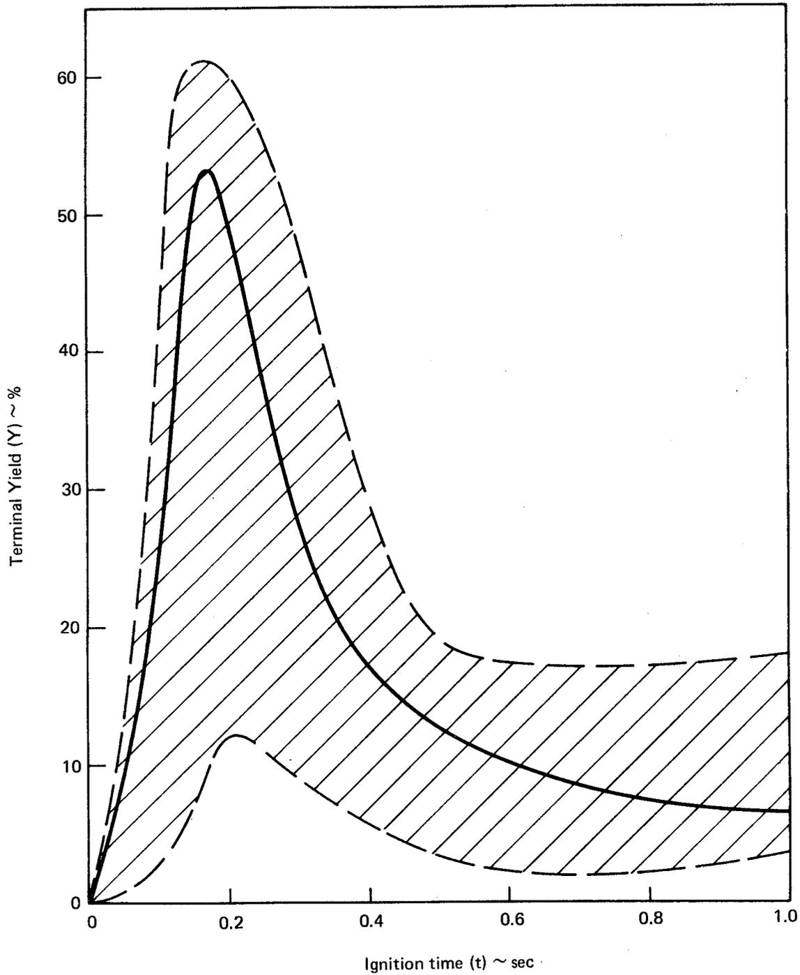
FIGURE 5-22. — TERMINAL YIELD VS IGNITION TIME FOR LO<sub>2</sub>/RP-1 CBM (REF. 54)
