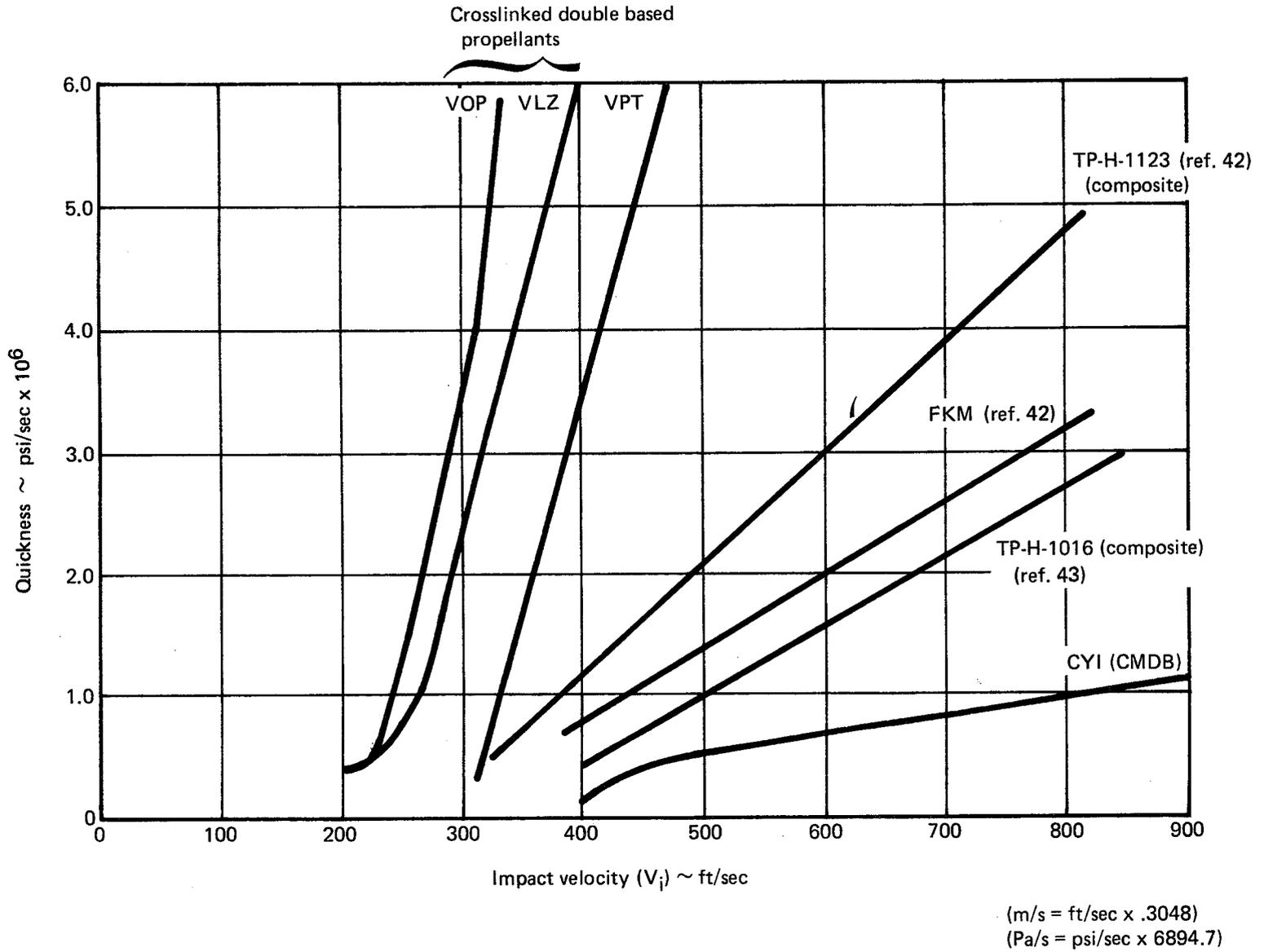
FIGURE 5-8. — QUICKNESS VS. VELOCITY COMPARISON OF VARIOUS PROPELLANTS (REF. 41)
