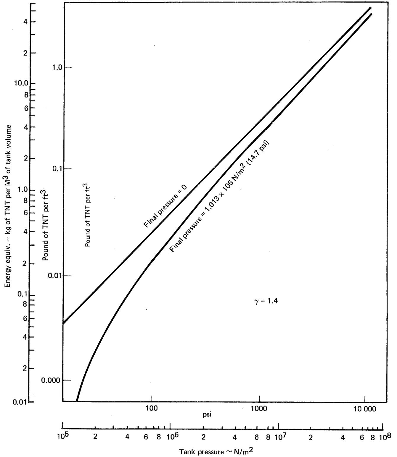
FIGURE 5-46. — COMPRESSED GAS TNT EQUIVALENT (REF. 62)
