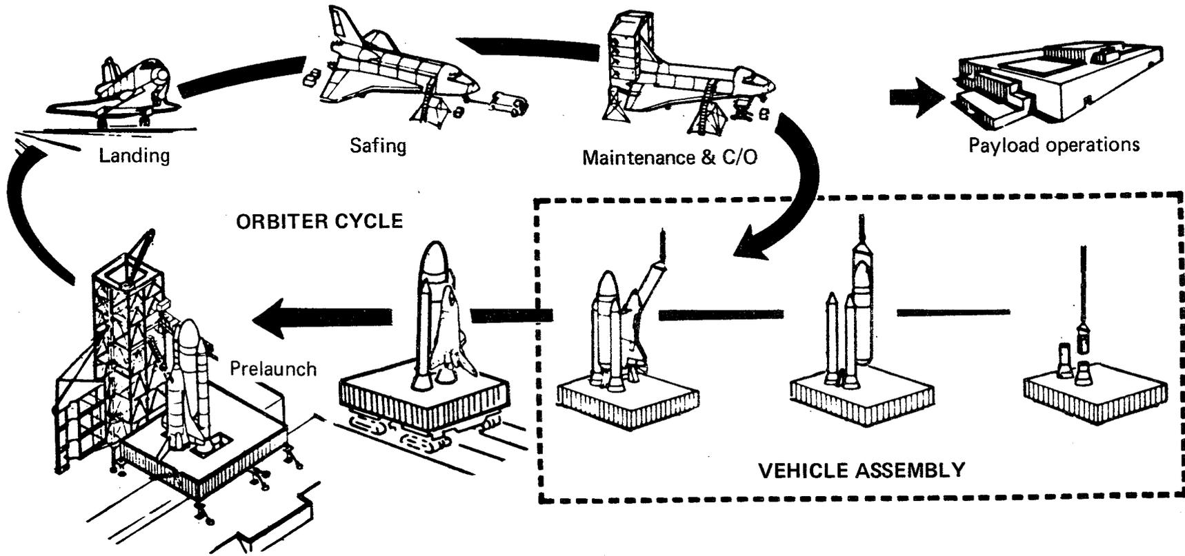
FIGURE 6-7. — KSC SPACE SHUTTLE SYSTEM GROUND FLOW
