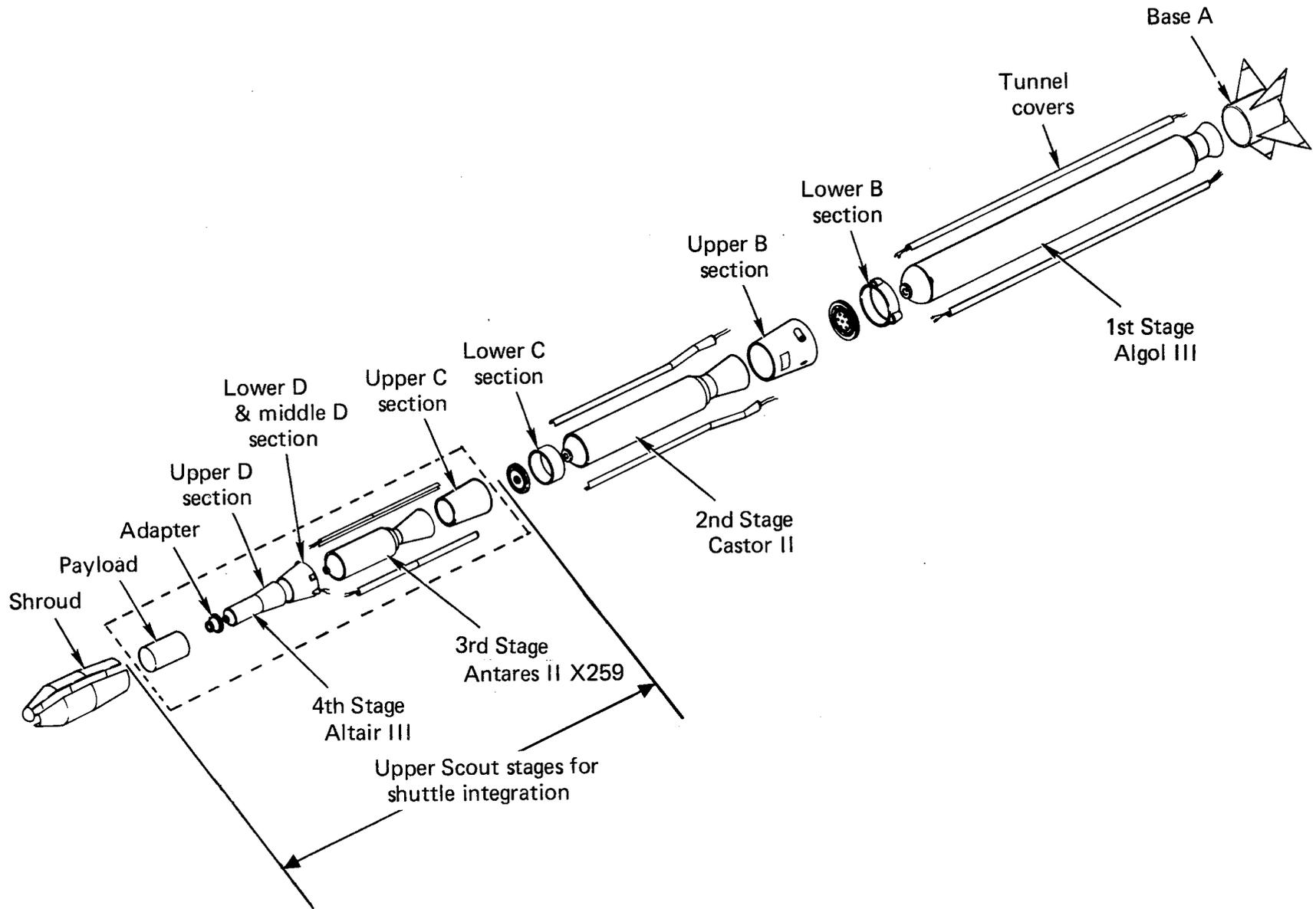
FIGURE 6-4. — SCOUT UPPER STAGE PROPULSION SYSTEM
