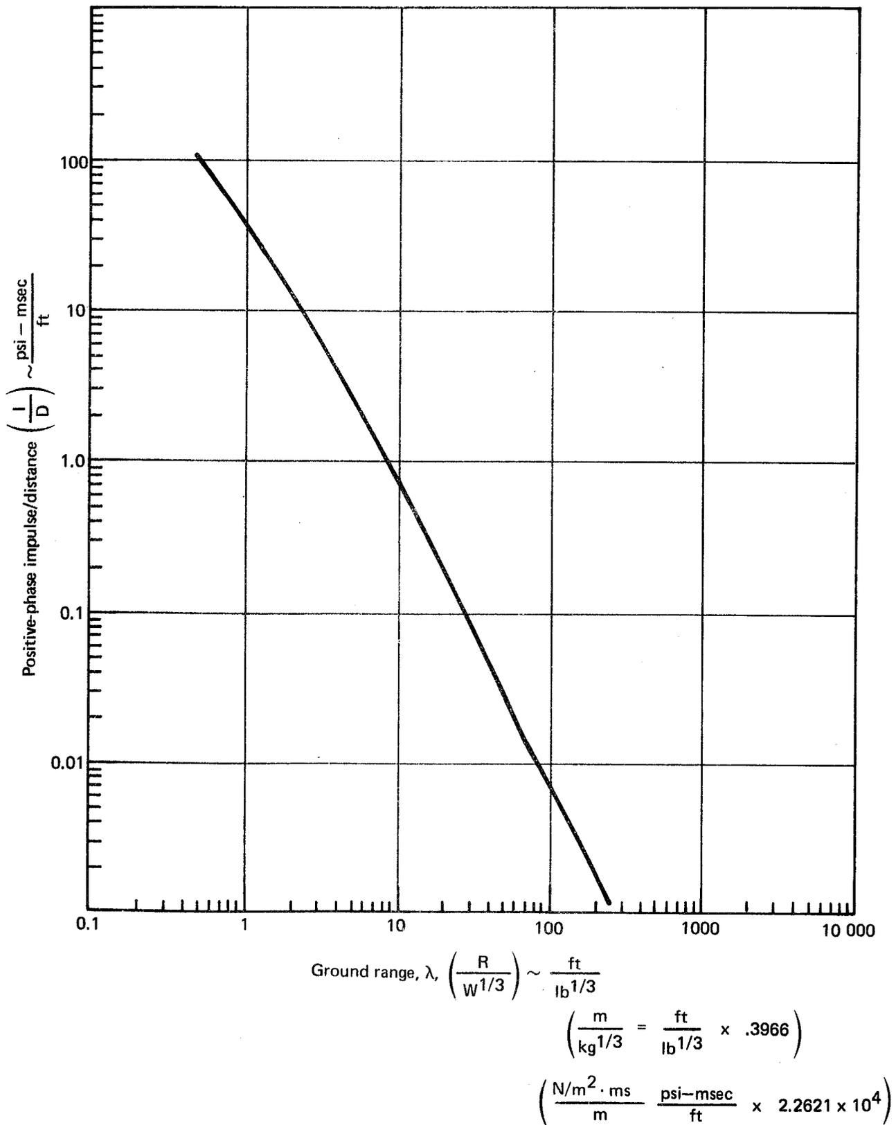
FIGURE 5-47. — PEAK OVERPRESSURE AND POSITIVE-PHASE IMPULSE VS SCALED DISTANCE FOR TNT SURFACE BURST (REF. 35)
