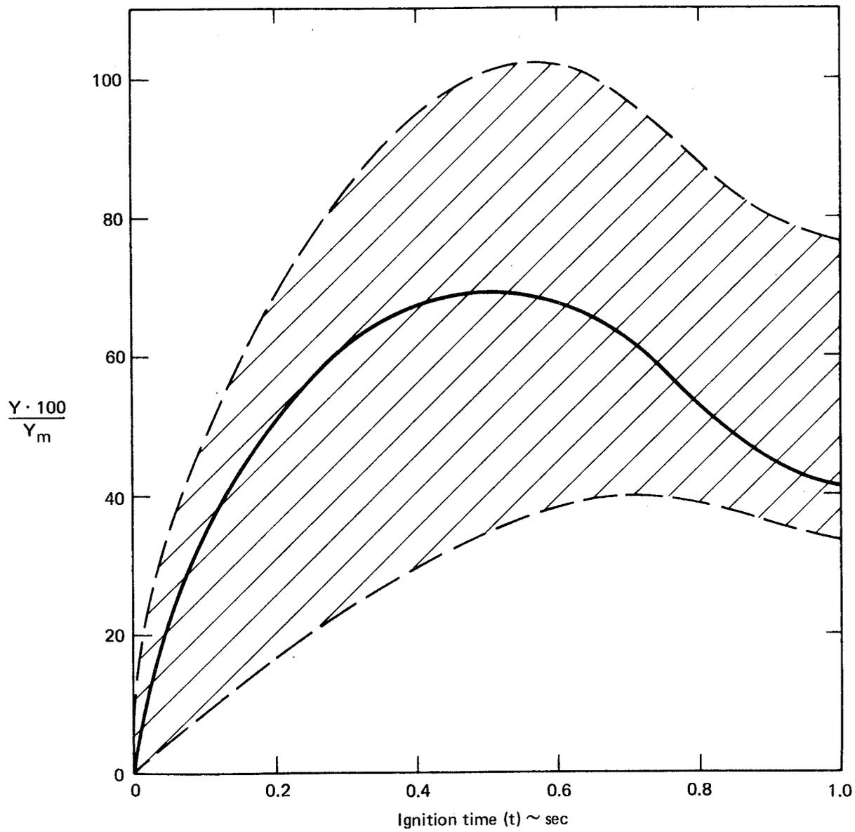
FIGURE 5-23. — NORMALIZED TERMINAL YIELD VS IGNITION TIME FOR LO<sub>2</sub>/RP-1 CBGS (REF. 54)
