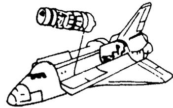
**RMS DEPLOYS ST FOLLOWING PLANNED MAINTENANCE OPERATIONS**
