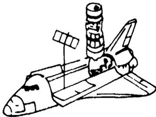
RMS MOVES SOLAR ARRAY TO RELEASE POSITION
