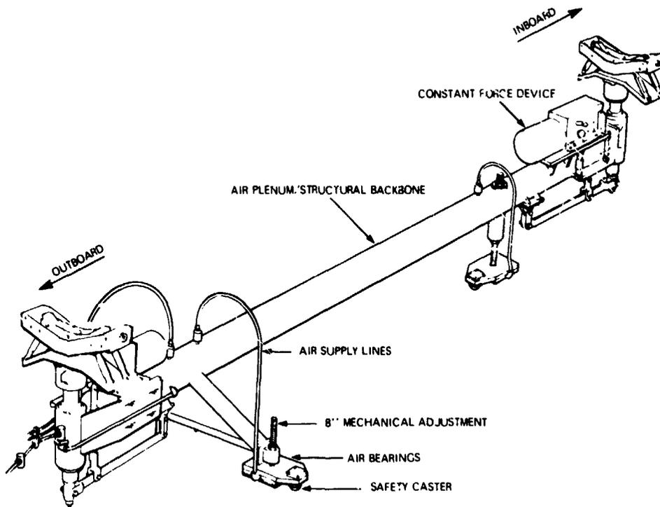
**FIGURE 3 SYSTEM TEST RIG LOWER RMS ARM SUPPORT**
