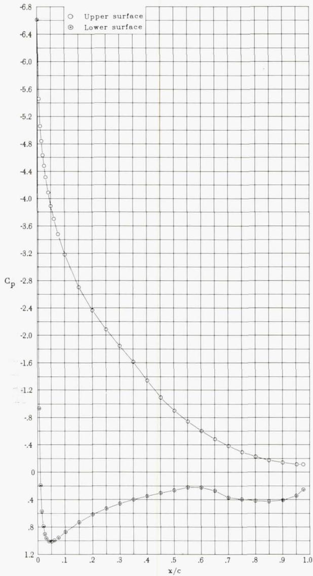
(ee)  $\alpha = 14.23^\circ$ ;  $c_l = 1.765$ ;  $c_d = 0.0249$ ;  $c_m = -0.085$ .
