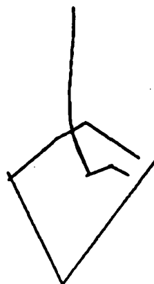
Longitudinal Mast Bending Mode - 36.66 Hz
