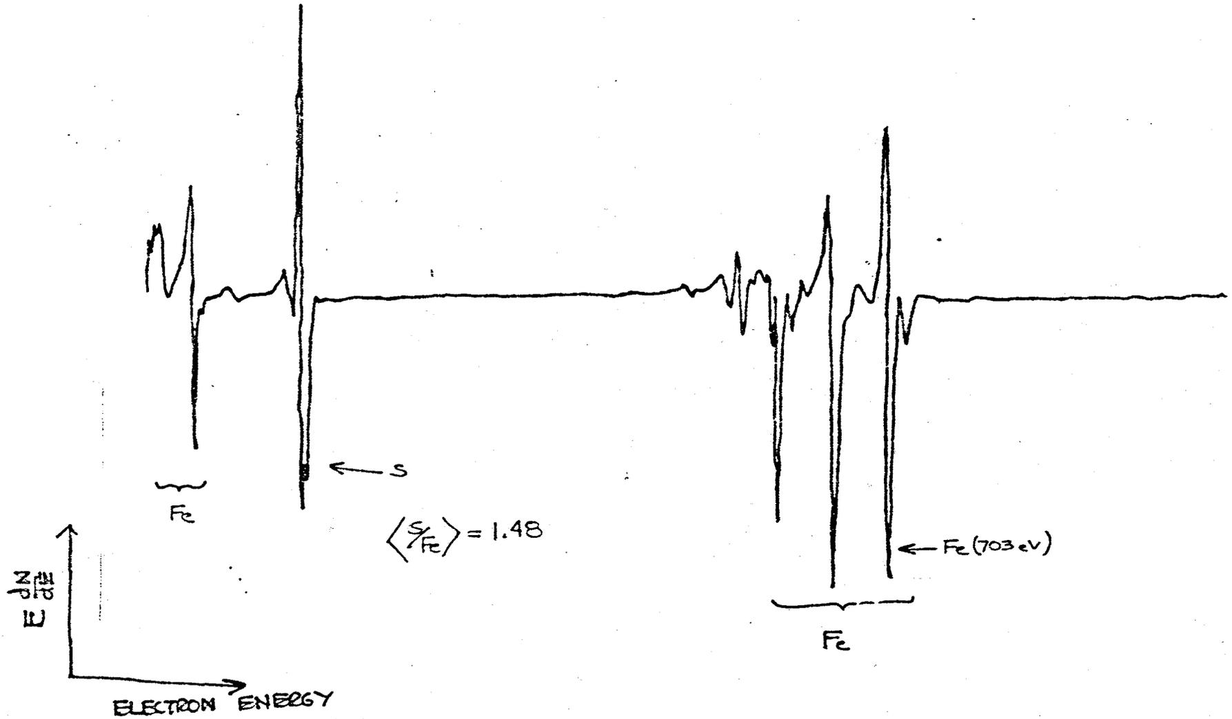
Figure 3.- AES spectrum for  $H_2S/Fe$ .
