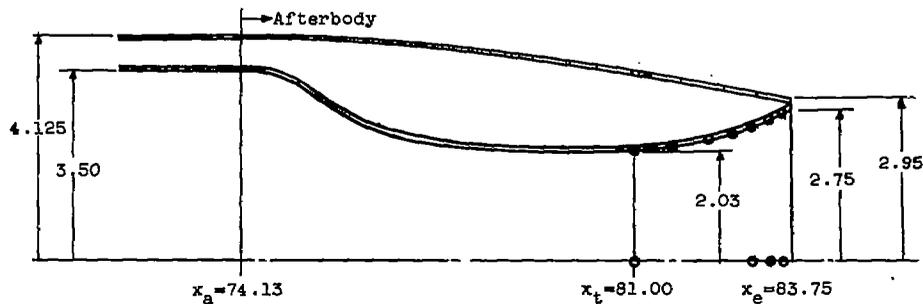
(d) Nozzle 4 (rapid divergent). Design pressure ratio, 9.1.
