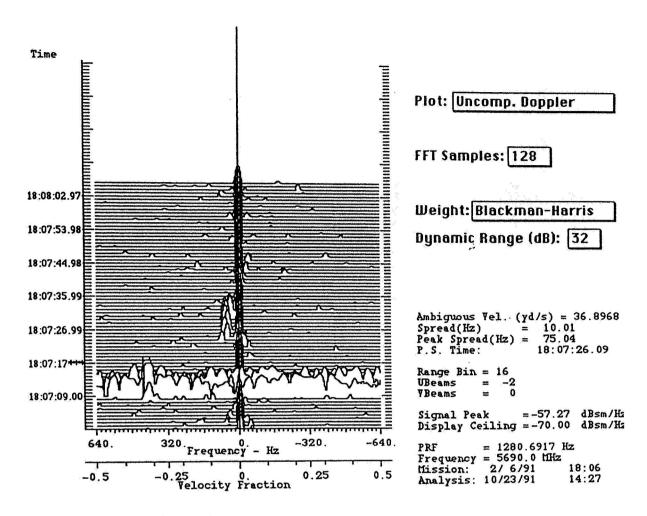
FIGURE 7(b) DOPPLER TIME HISTORY PLOT FOR A-7 FLY-BY MIDDLE BEAM, RANGE GATE 16, AXIAL CASE
