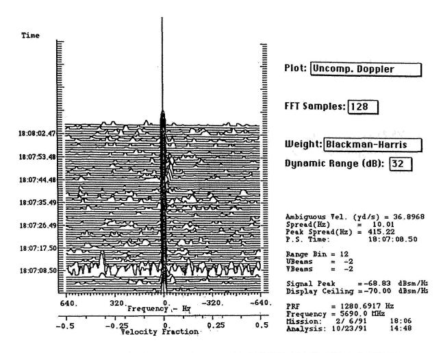
FIGURE 8(A) DOPPLER TIME HISTORY PLOT FOR A-7 FLY-BY, LOWER BEAM, RANGE GATE 12, AXIAL CASE
