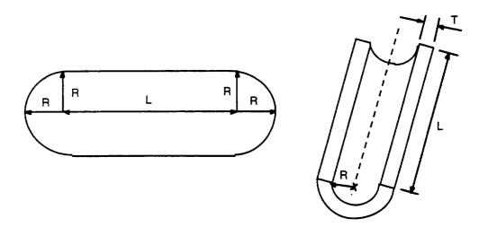
Figure 5.12. Thin-Walled Pressure Vessel
