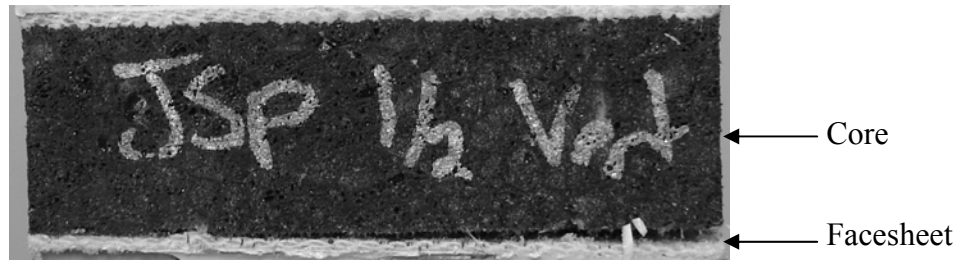
a. Initial edge delamination.
