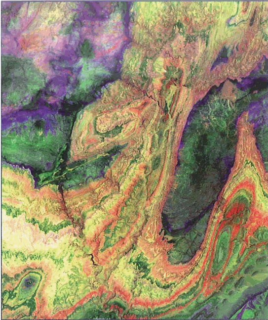
ASTER画像：短波長赤外バンドは、その組み合わせにより岩石の種類の違いを際立たせ、モロッコのアンチアトラス山脈の複雑な褶曲を画像化します。帯黄色、橙色、緑色の部分は、石灰岩、砂岩、石膏を示し、濃青色と緑色部分は下層にある花崗岩を示しています。
