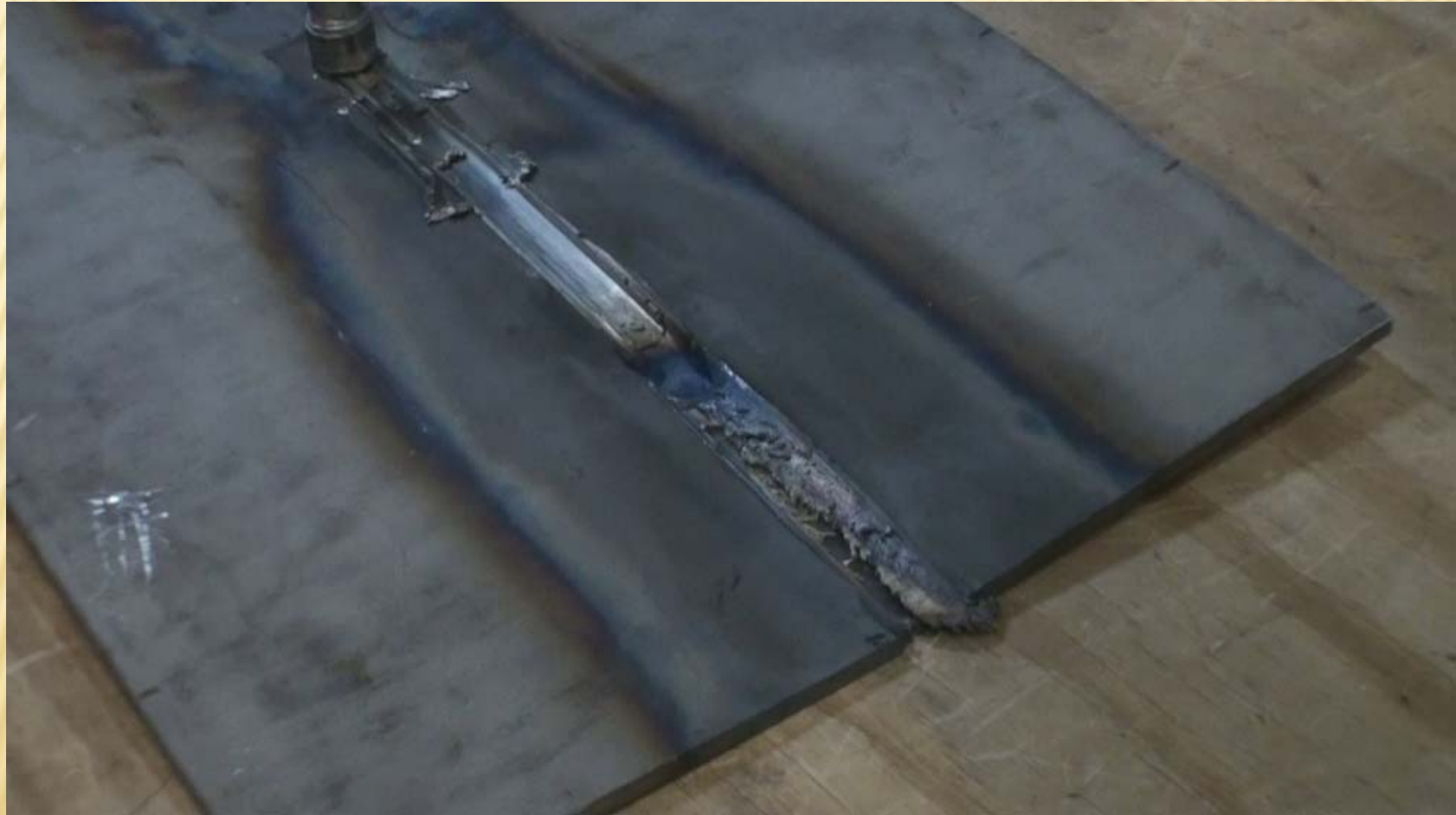
Ti 6-4 bead on plate.
