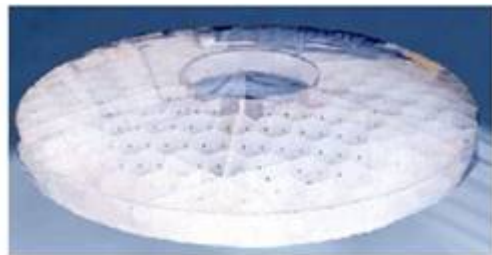
ITT's 2.4m ATT Demonstration Mirror
