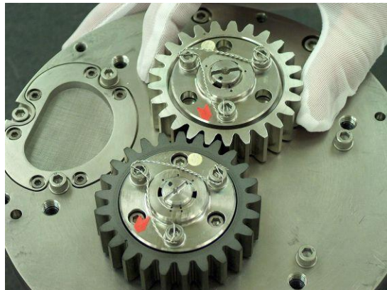
Figure 10. DA Compressor Gears
