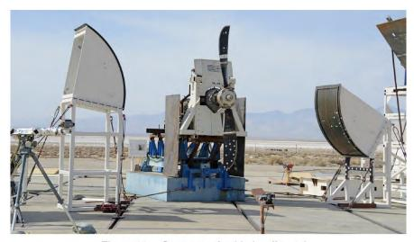
Figure 11.—Open-rotor fan blade-off test rig.
