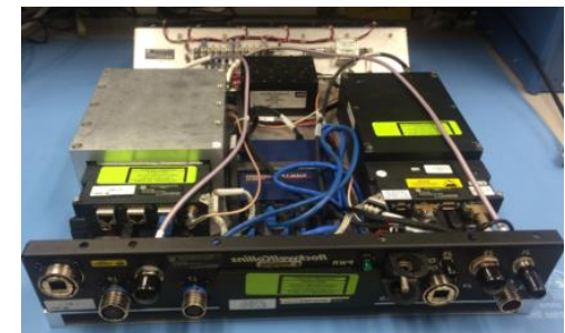
CNPC Gen-5 radios (L & C-Band)
