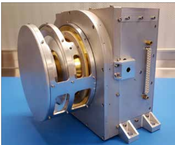
► The Bifocal electron sensor.
