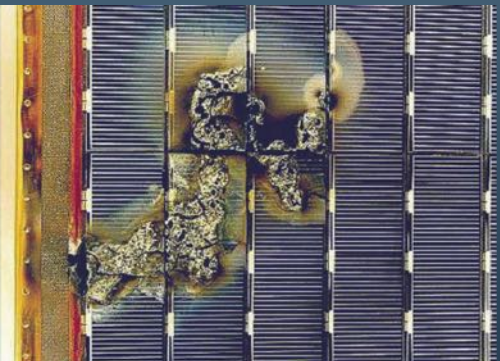
ESA EURECA satellite solar array sustained arc damage.Credits: ESA
