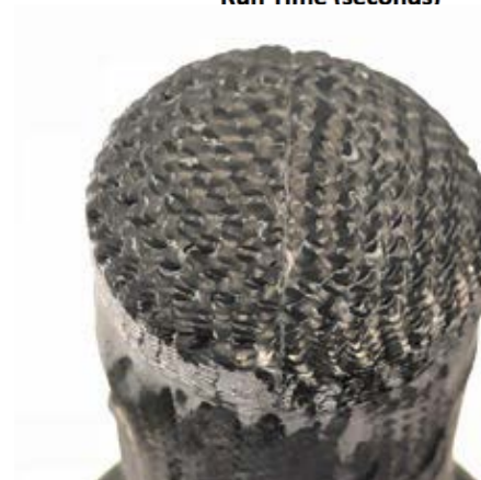
IHF 3": Hot Wall Heat Flux: 3500 W/cm 2 Pressure: 5 bar
