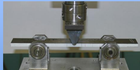
End Notch Flexure (ENF) 3 Point Bend
