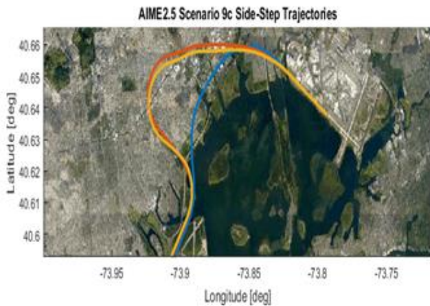
Fig. 12. Trajectories for drone encounter scenario.
