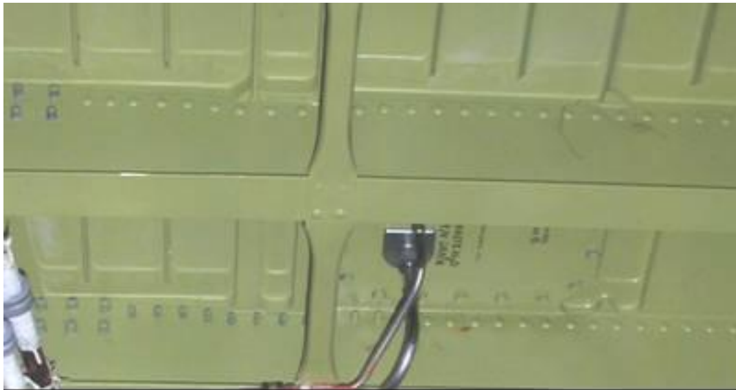
Estructura recubierta con Koropon en el Orbitador “Enterprise”
