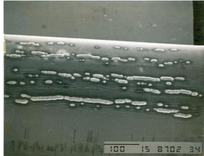
Plata cubierta con oro donde se ve la formación de óxido de plata causada por oxígeno atómico en los defectos del recubrimiento
