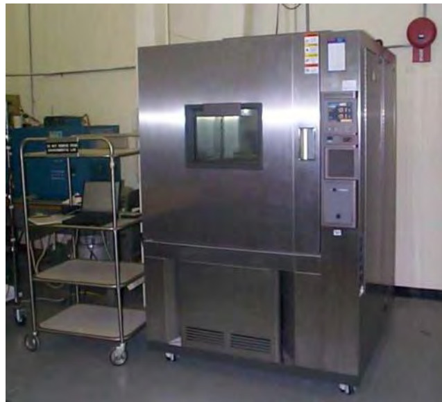
Figure 27: Espec ESZ-4CA Thermal Chamber
