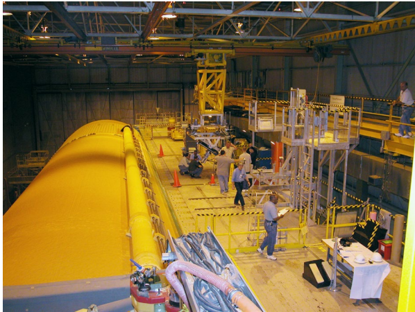
ET Foam Inspection
