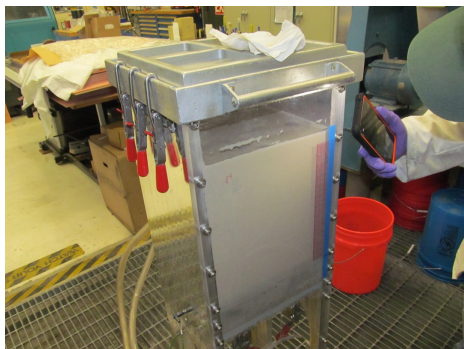
4. Pour into casting tower
