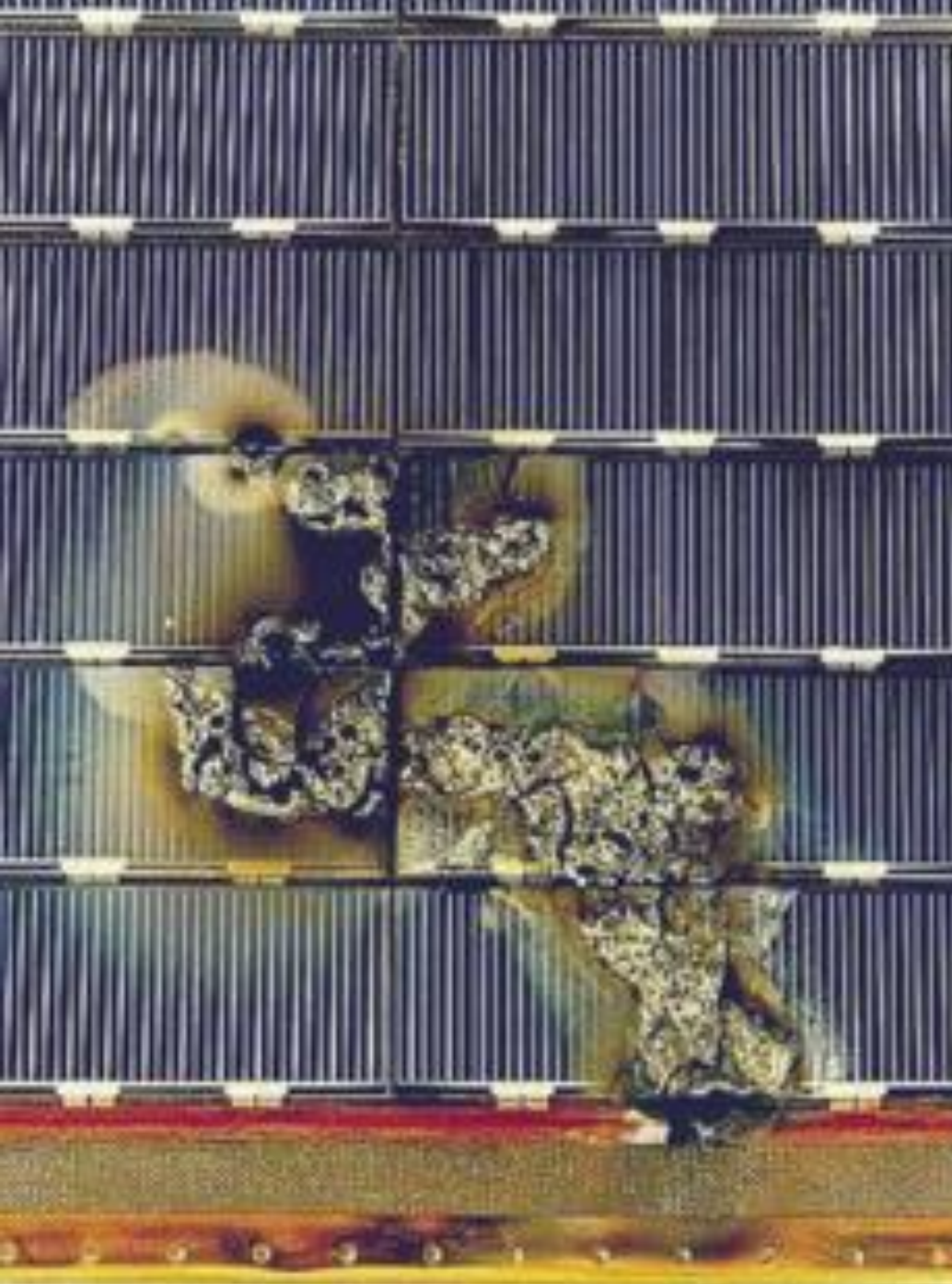
ESA EUREKA satellite solar array arc damage (Image: ESA)
