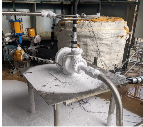
Fig. 15: LLRV Post LH 2 Test
