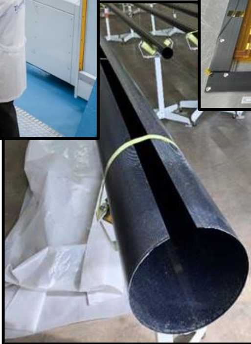
PPE Roll Out Solar Array (ROSA) Boom
