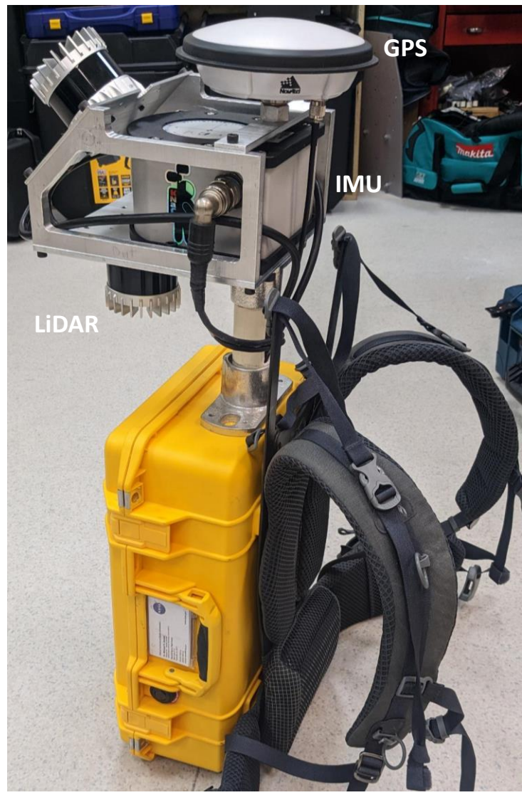
Fig. 1. The KNaCK Instrument.
